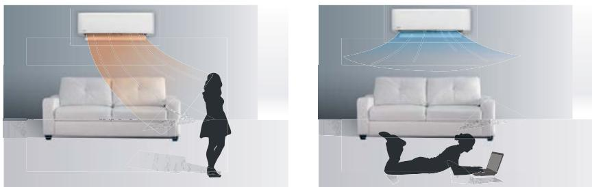
Датчик, расположенный во внутреннем блоке кондиционера, фиксирует отсутствие движения в помещении и переводит кондиционер в работу с пониженной производительностью, что позволяет экономить расход электроэнергии.
